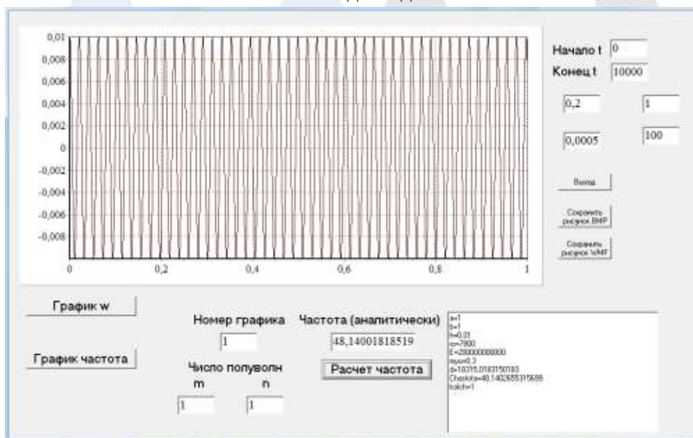
Рис.1. Расчет частоты собственных колебаний пластины.
